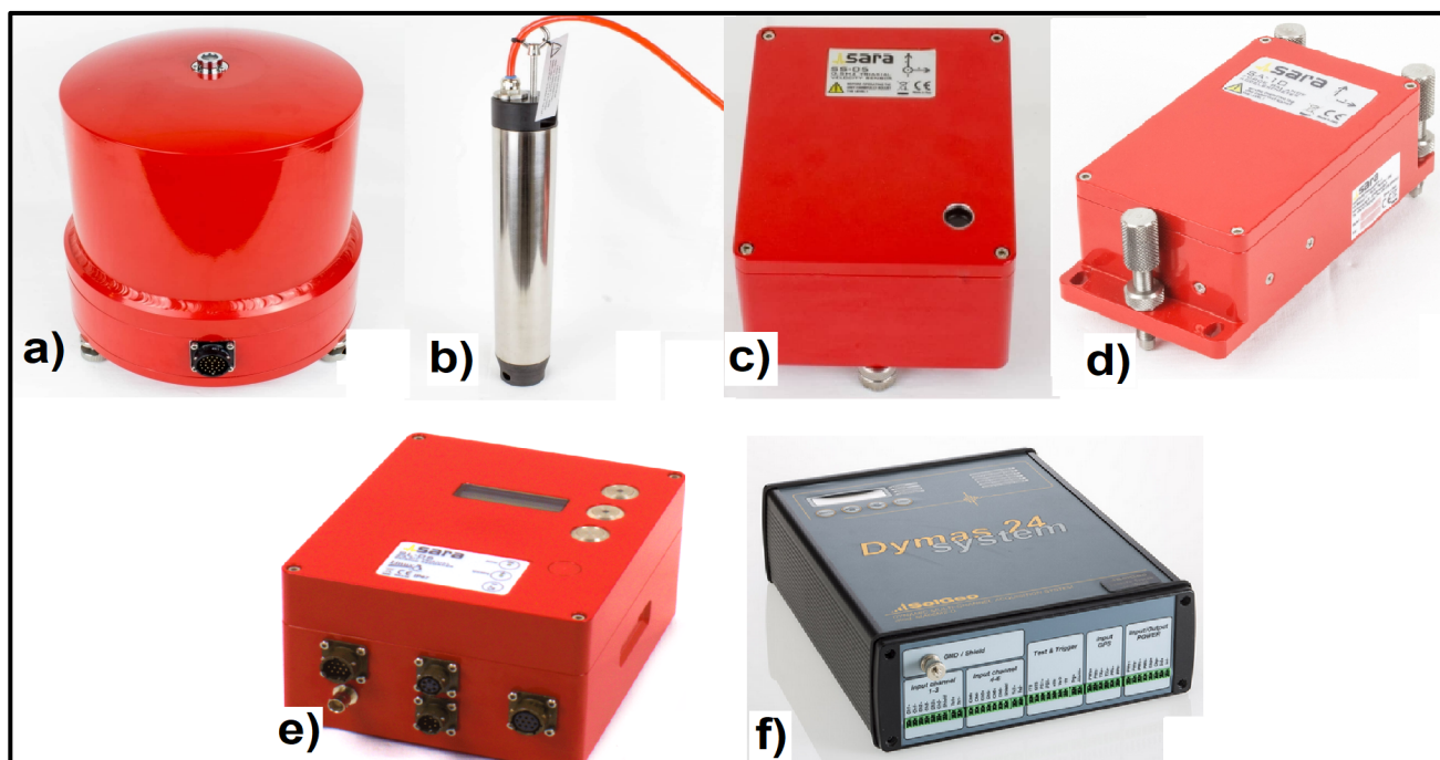
Fig. 2.2– Foto degli strumenti installati nella rete SP: a) sismometro a banda larga SARA SS08; b) sismometro da foro a breve periodo SARA SS10BH; c) sismometro di superficie a breve periodo SARA SS02; d) accelerometro a bilanciamento di forza SARA SA10; e) digitalizzatore SARA SL06; f) digitalizzatore SOLGEO DYMAS24.
