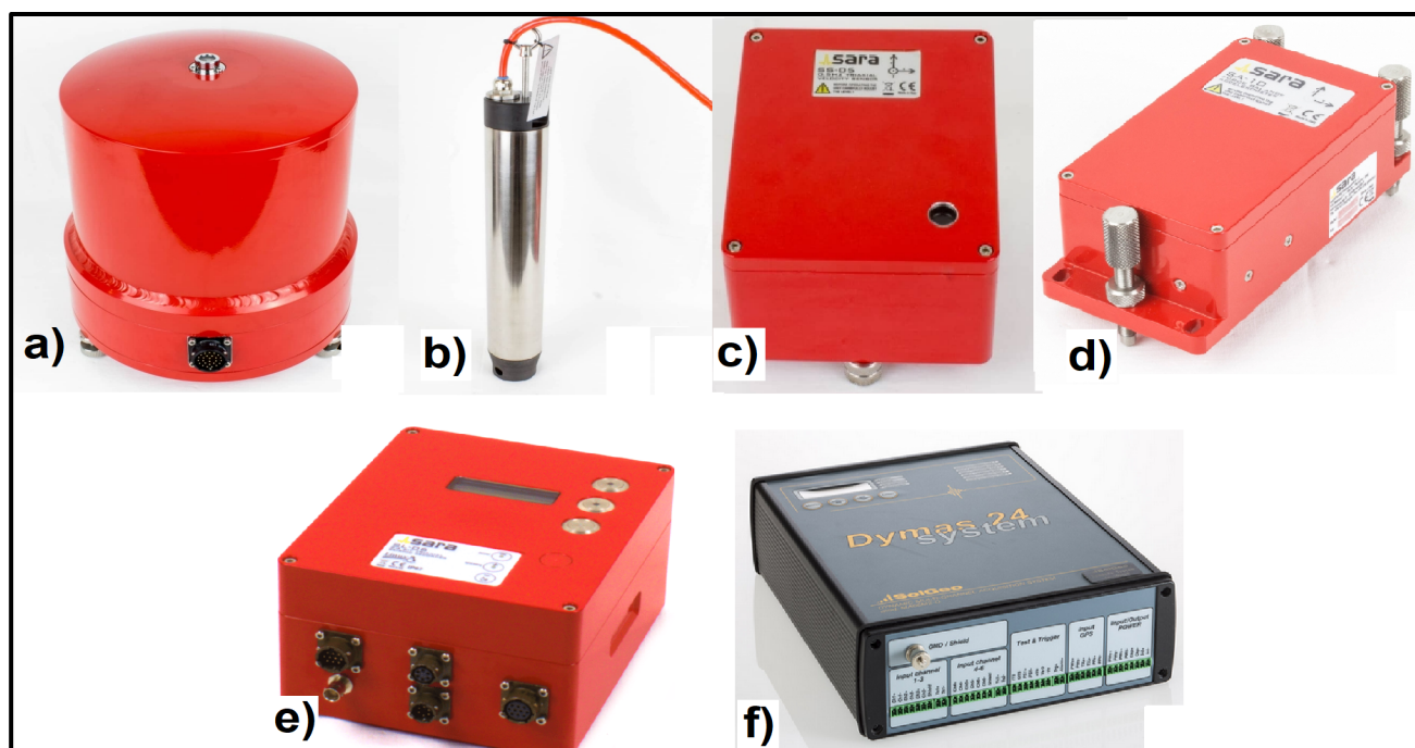
Fig. 4.2– Foto degli strumenti installati nella rete SP: a) sismometro a banda larga SARA SS08; b) sismometro da foro a breve periodo SARA SS10BH; c) sismometro di superficie a breve periodo SARA SS02; d) accelerometro a bilanciamento di forza SARA SA10; e) digitalizzatore SARA SL06; f) digitalizzatore SOLGEO DYMAS24.
